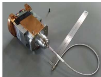
複数のLD素子の光を1本のファイバに集約して放出するLDモジュール
